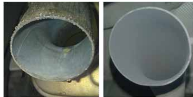
Roetfilter weg, dat zie je toch aan de uitlaat? Niet altijd. Links Renault Mégane, rechts Ford Focus, beide vóór uitbouw van het roetfilter.
