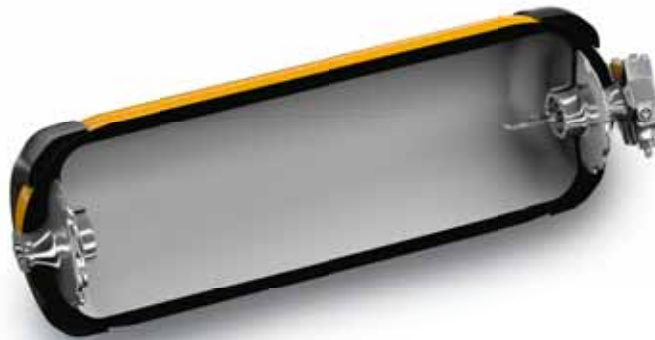
De waterstof tanks in de Mirai bevatten sleuteltechnologie. Ze zijn uit drie lagen opgebouwd, lichter dan voorheen en ze bevatten minder kostbare materialen dan voorheen.
