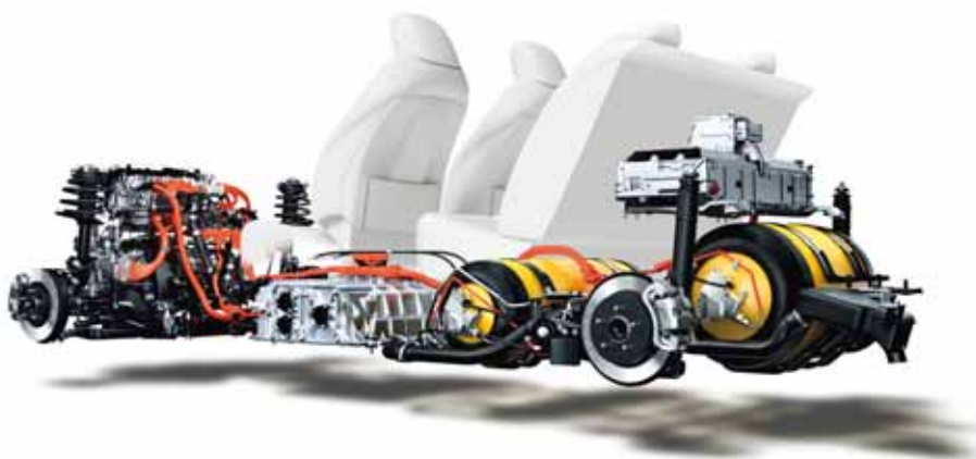
Doorkijkje van de Toyota Mirai. Achterin de carbonversterkte 122 liter tanks, erboven een klassiek NiMH-accupakket, centraal de brandstofcel 'stack', voorin regelunit, omvormers en aandrijving.
