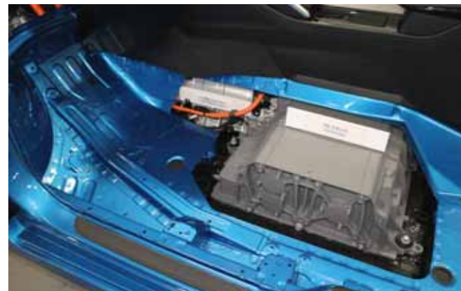
Hoe hoger de spanning, hoe lager de stroom, hoe kleiner de verliezen. De boost converter verhoogt de spanning die de brandstofcelstack levert tot 650 volt.
