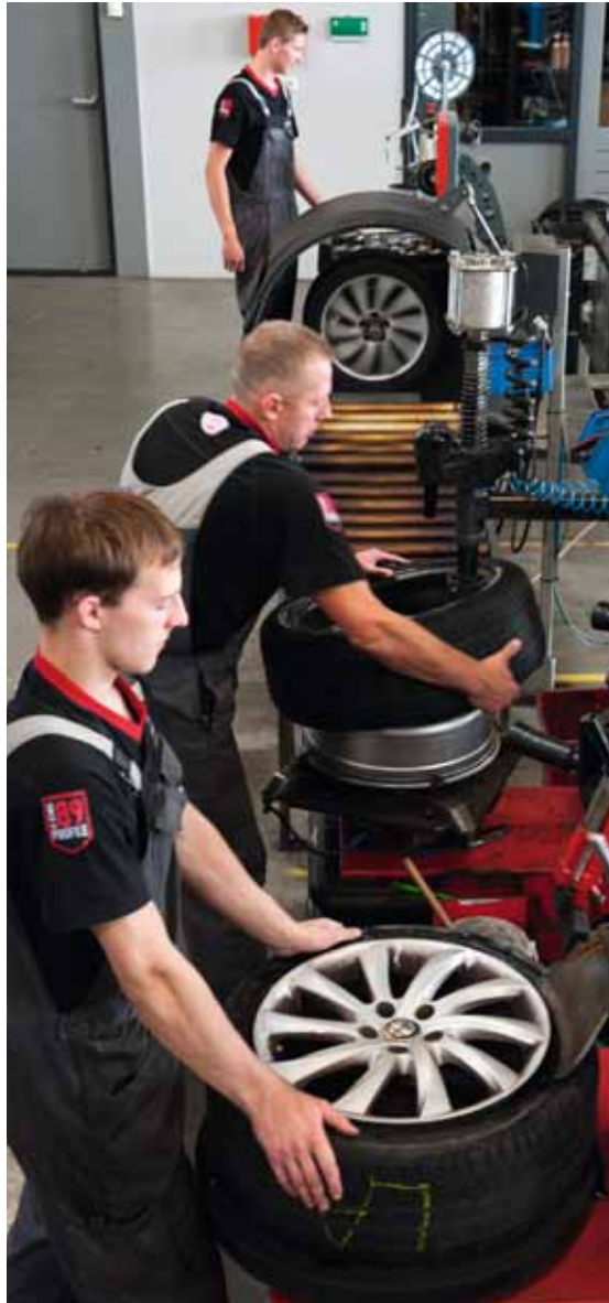
Op de Ahcon-montagestraat drukt Guido de band van de velg, monteert Jacob een nieuwe band op het de- en montage-apparaat en balanceert Kenny (boven in beeld) de band/wiel-combinatie. Tijdens de wisselwerken kan er zo razendsnel gewerkt worden.
