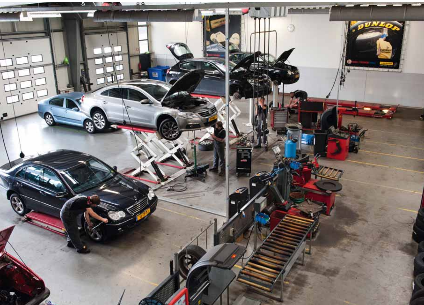
Technicus Guido werkt aan de Mercedes aan de eerste van de drie schaarbruggen. Achteraan staat een tweekolommer en boven in beeld de uitlijn/APK-schaarplatenbrug. Onder in beeld de wisselstraat, die topdrukte aan kan tijdens de wisselweken.
