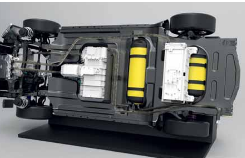
De brandstofcelstack van de Toyota Mirai is ingebouwd onder de vloer, ter hoogte van de voorstoelen. Voorin vinden we de omzetter. De twee waterstof tanks bevinden zich onder en achter de achterbank, net als de Ni-Mh hoogvoltage batterij.
