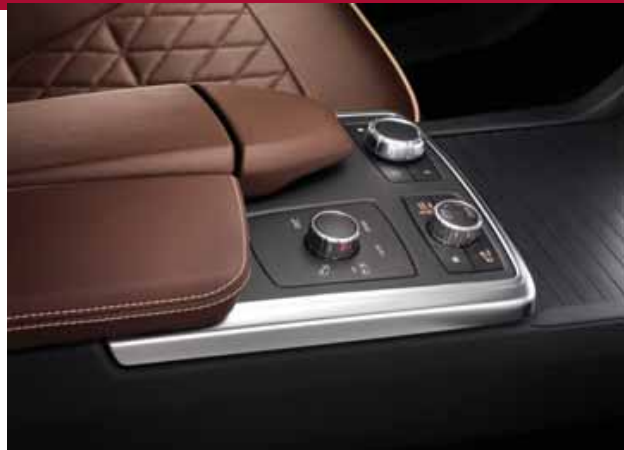
De diverse rijprogramma's en de wagenhoogte kunnen vanaf de middenconsole met twee draaiknoppen worden ingesteld. De derde, wat grotere knop is voor de COMAND-bediening die we ook uit andere Mercedes-modellen kennen.
