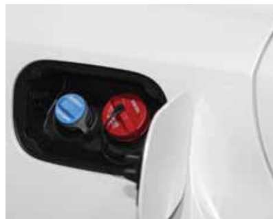
De vulopening voor AdBlue zit naast de dieselvuldop.
