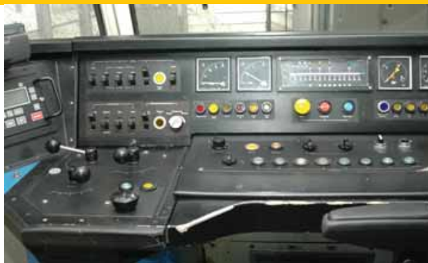
Blik in de SGM (Sprinter) achter het deurtje van de machinist. Let op de acht groene knoppen. Dat is de cruise control.
