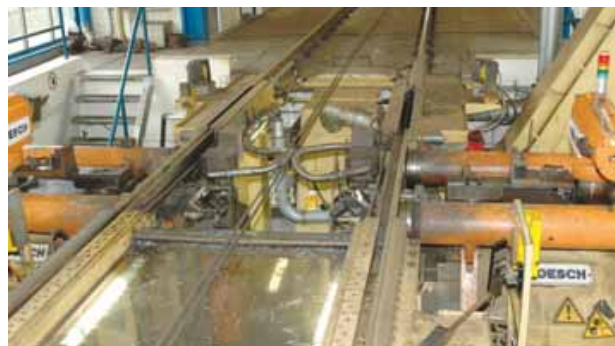
De kuilwielenbank, een CNC-gestuurde draaibank onder een stuk verschuifbare rails. Heeft de functie van de wielbalancer in het autobedrijf.
