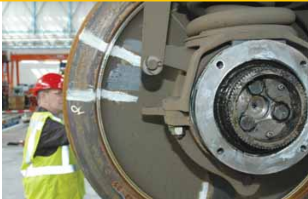
Waarom die streepjes op de wielen staan? De wielbanden zijn op de wielen gekrompen. Door oververhitting kunnen ze loskomen en verdraaien. De wielmarkeringen verraden dat.
