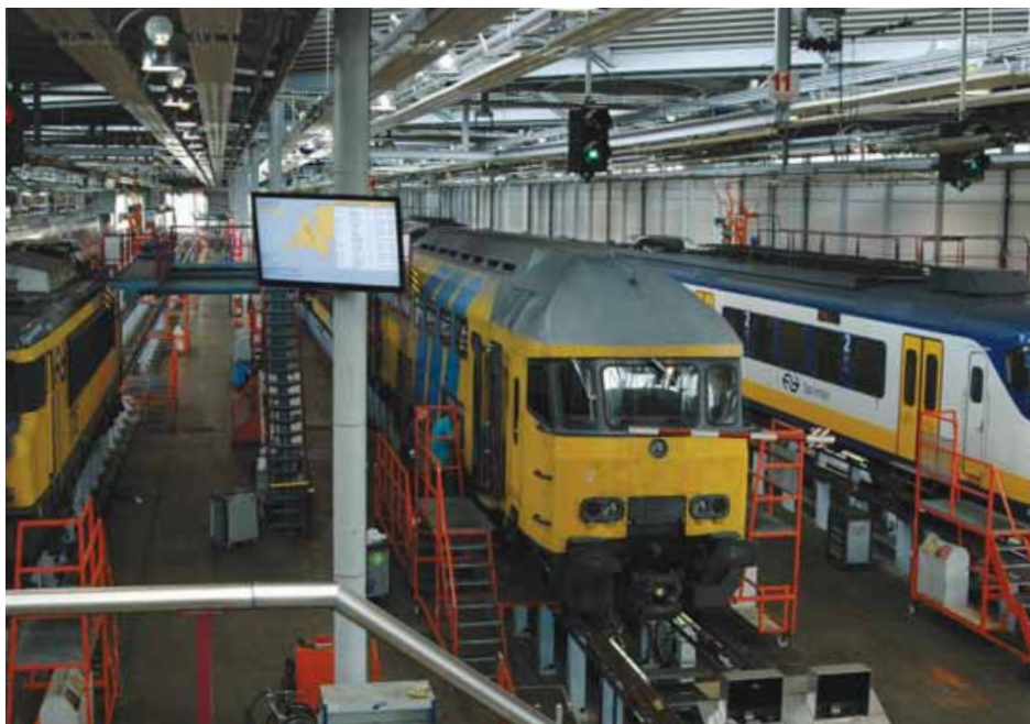
Blik op de werkplaats van NedTrain in Leidschendam. De treinen staan verhoogd op open werkputten. Let op de terminals aan de kop van het spoor.
