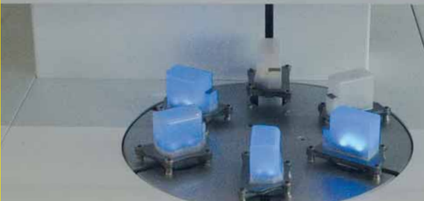
Batterij-wisselstation. De standaard huurbatterij wordt losgekoppeld van de auto, zakt naar beneden, komt in een carrousel, terwijl een opgeladen exemplaar omhoog naar de auto gaat. De wissel kan in twee minuten.
