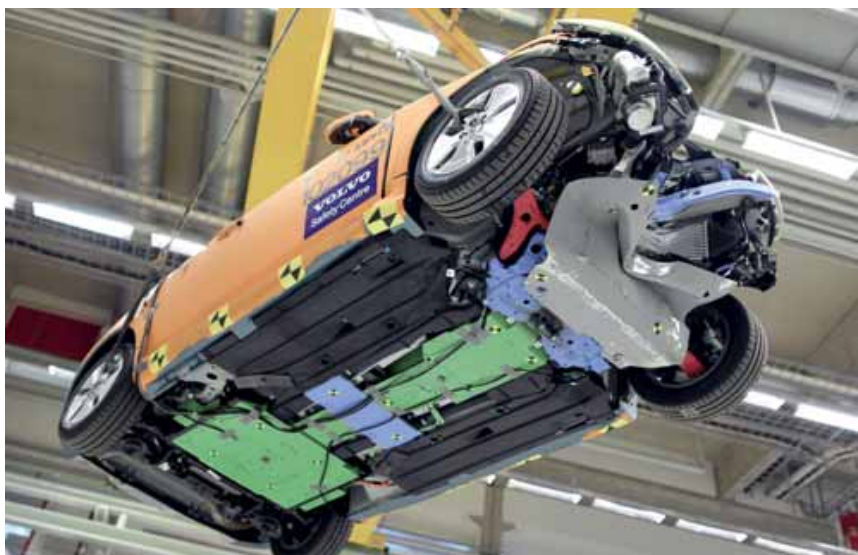
C30 Electric na een crashtest in Volvo's Safety Center in Gothenburg. Het T-vormige groene deel met de batterij is volledig intact.
