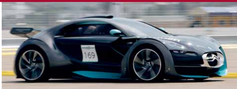
Citroën Survolt: buizenchassis, veel carbon, 1150 kg, 221 kW, topsnelheid 260 km/u en een kilometer met staande start binnen 22 seconden. Nee, elektrisch rijden hoeft niet saai te zijn.
