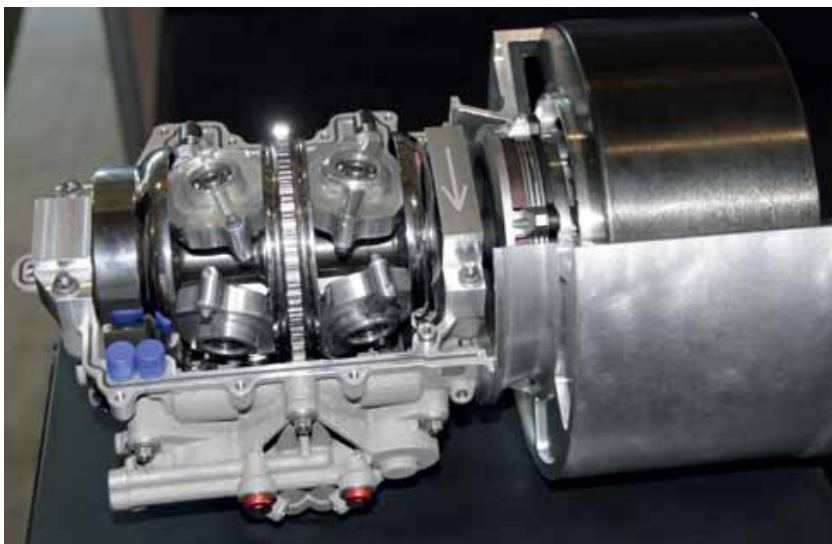
Het KERS-systeem werkt met een variabele transmissie (links) en vliegwiel rechts. De cvt is zowel werkzaam bij het opladen van het vliegwiel, als het afgeven van de kinetische energie.
