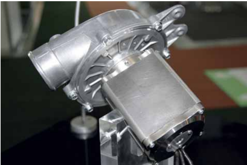
De elektrische compressor is zeer compact geconstrueerd en bouwt binnen 0,5 seconde de maximale druk van 3 bar op. Nagenoeg hetzelfde apparaat kan andersom werken, als turbine waarbij de elektromotor als generator werkt.
