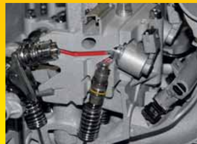
MultiAir variabele klepbediening van de prijswinnende Fiat TwinAir-motor.
