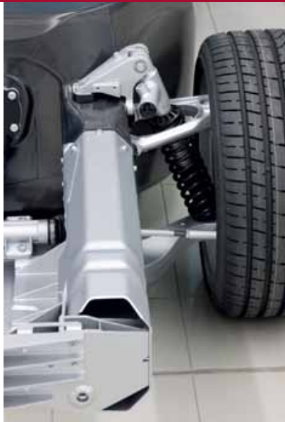
Een blik op de voorwielophanging laat goed zien hoe subframes van aluminium profielen het koolstofvezelchassis completeren. Bovenaan de veer/demper ziet u een van de ProActive-regelventielen, aan de achterkant van de demper zit er nog een.
