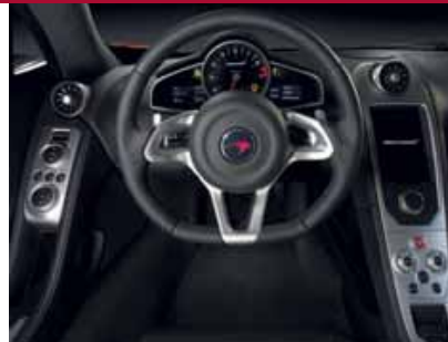
Een echte 'cockpit', met in het portier de klimaatregeling. In het middenconsole geen schakelbediening, achter de onderaan nog net zichtbare elektrische handrem zijn er alleen knoppen D, N, R voor vooruit, neutraal en achteruit. De zilverkleurige draaiknoppen stellen demping en schakeling in op N(ormaal), S(port) of T(track), eronder drukknoppen voor winterstand, launch control en automatische regeling (active).
