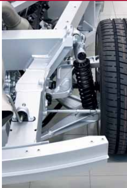
Achter net als vooraan wielophanging met aluminium dubbele driehoeksarmen, eentje in echte driehoeksvorm en eentje in L-vorm. Er is achter ook een spoorstang, voornamelijk als afsteuning tegen de aandrijfkraft en om de wielstand te kunnen instellen.
