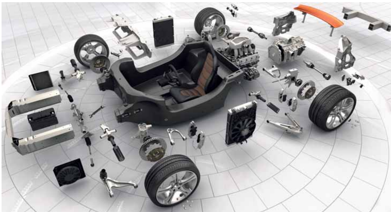
Buitengewoon interessant overzicht van belangrijke MP4-12C onderdelen, met voorop de centrale dragende koolstofvezel MonoCell. Bedenk ook dat dit een virtuele presentatie is: al deze zwevende onderdelen zijn computerprojecties. Het geheel geeft een sterke indruk over welke enorme rekenfaciliteiten het technisch centrum van McLaren in het Britse Woking beschikt.
