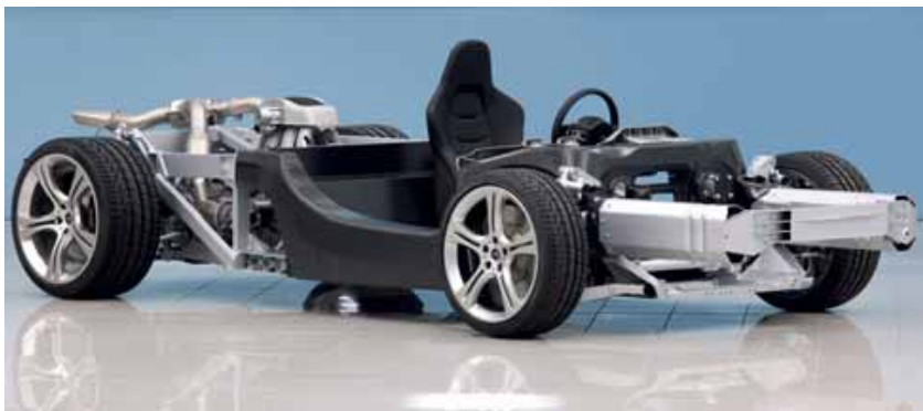
Een complete McLaren zonder jas laat nog eens het samenstel tussen aluminium en koolstofvezel chassisdelen zien. De uitlaten lopen omhoog om een zo glad mogelijke bodem te realiseren met minimale opwaartse rijwinddruk. Hier is er geen uitlaatdemper, een productiemodel heeft dat wel. McLaren noemt het een 'mixing box', er is gewicht gespaard door geen normale demper toe te passen, maar de uitlaatpuls van de cilinderbank elkaar te laten uitdempen.
