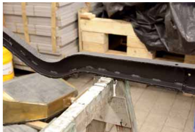
Een goede restauratie moet omkeerbaar zijn. Aan de achterkant van dit Regal-chassis werd het staal te dun door oxydatie. Er is een versterking ingelast, waarmee het chassis haar oorspronkelijke sterkte terugkreeg. De aanpassing is altijd ongedaan te maken.
