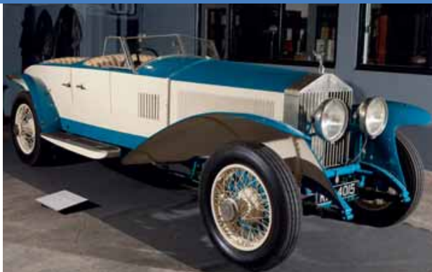
Rolls-Royce bouwde in 1925 de eerste van een aantal experimentele auto's. Het doel was om door middel van een laag gewicht en aandacht voor stroomlijn een topsnelheid te halen van 100 mijl per uur (160 km/u). Deze Continental Phantom I is '10EX', met een carrosserie van Barker. De auto kreeg bij een vorige restauratie een weinig flatteuze kleur. Dat moet nog een keer over.
