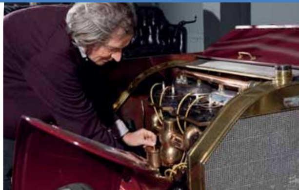
Jan Bruijn vlottert even wat benzine voor de machtige FIAT. De vier cilinders hebben een gezamenlijke inhoud van 6,9 liter. Door de grote motor en het jonge bouwjaar (1904) staat de auto garant voor een vroege aankomst in Brighton.
