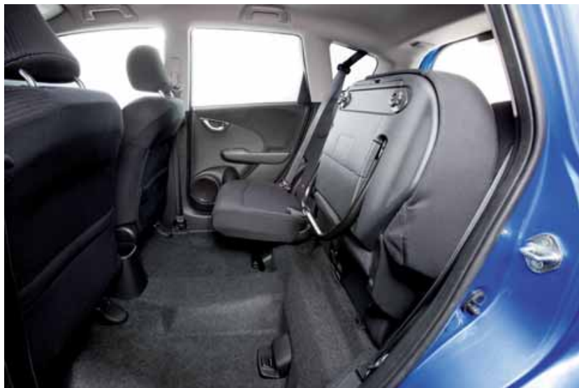
Slimme ruimtebenutting, met tank onder de voorstoelen en lage vloer onder de achterbank. Bij opgeklapte zitting is er 1,28 meter laadhoogte beschikbaar. Bedacht voor de Jazz, daarna ook toegepast bij de Insight en Europese Civic hatchbacks.
