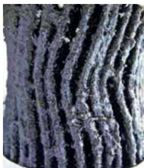
Ziet het brandstoffilter er zo uit? Hoogste tijd voor ongediertebestrijding en grote schoonmaak in de tank.
