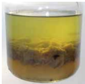
Moderne diesel met een beetje water, bewaard op een warme plek. Boven diesel, in het midden slijm en onder water.
