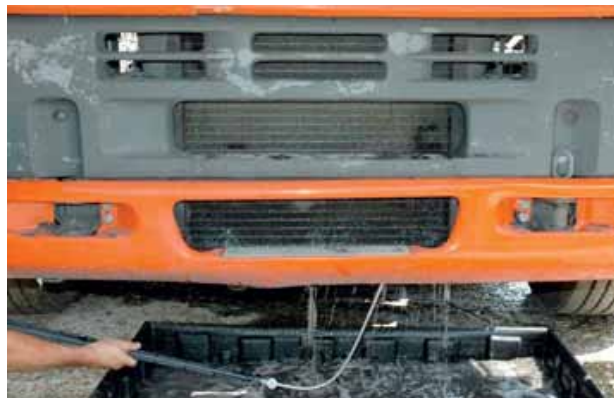
Reiniging van het koelpakket zonder demontage.
