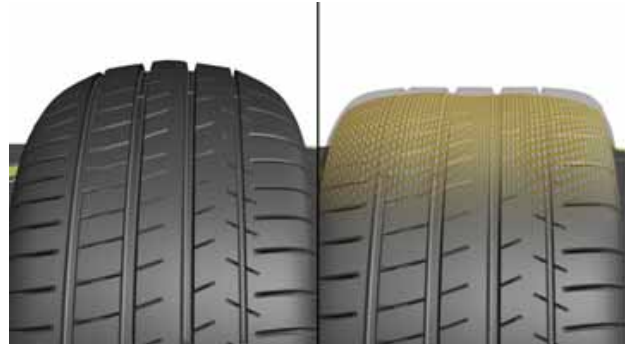
Bij hoge snelheid gaat een band bol staan en vermindert het wegcontact. De Twaron-gordel met zijn variërende spanning (rechts) houdt het loopvlak in vorm.
