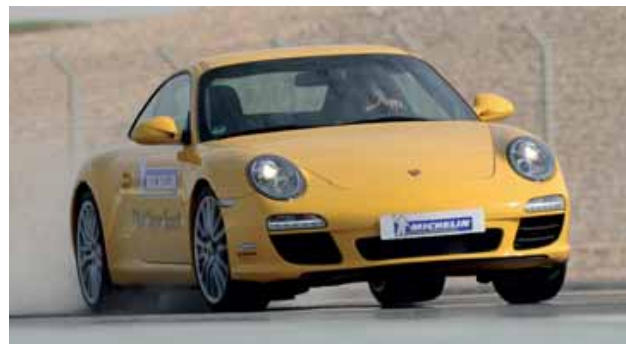
Snelle bocht naar links. De rechterbanden moeten het werk doen. De druk op de buitenkant van het loopvlak loopt op.
