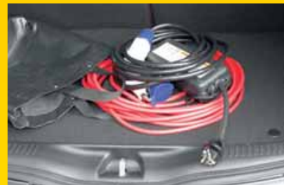
Een oplaadsnoer met controledeels, en een verlengsnoer. Zeker weten, dat het niet erg is als ze buiten in de regen liggen? Mitsubishi beveelt aan de deels met controlelampjes op te hangen; maar als ik nou geen boom of hek vlak naast mijn parkeerplaats heb, hoe moet dat dan?
