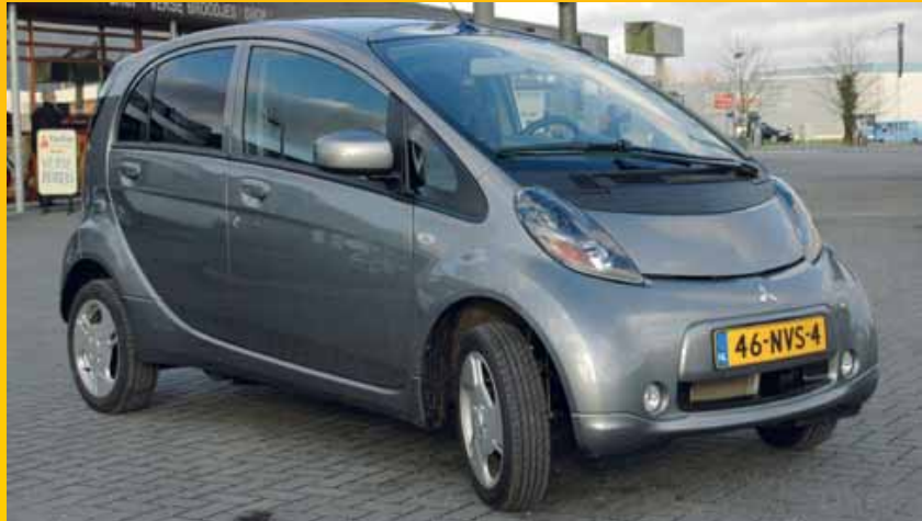
De compacte stadsauto i-MiEV werd voor de Europese markt iets opgerekt en biedt acceptabele ruimte voor passagiers en bagage. Aandrijving is op de achterwielen, vandaar dat de achterbanden breder zijn dan het schoeisel op de voorwielen.
