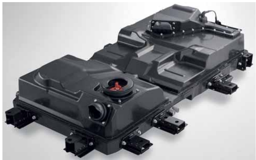
Het in tweeën gedeelde accupakket ligt op een stalen frame. Vooraan de hoogspanning stroomaansluiting, achteraan de opgebouwde ventilator voor luchtkoeling van de accu's.
