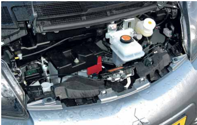
Onder het voorklepje huizen alleen wat hulpaggregaten, zoals de 12 V accu, elektrische vacuümpomp voor de remmen, elektrische kachel en aircompressor.
