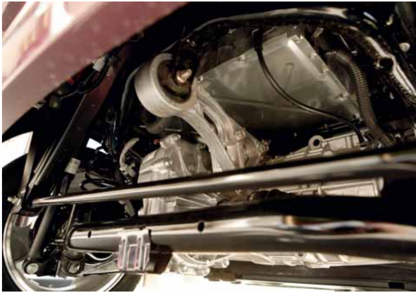
De weinig meer toegepaste De Dion-as loopt om de aandrijflijn heen van wiel naar wiel. Links van de grote aluminium motorsteun differentieel en tandwielkast, rechts van de steun van elektromotor, daarboven de gelijkrichter.
