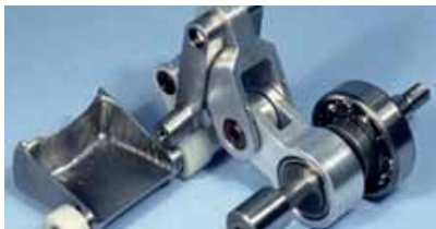
Ook al geen simpel mechaniek, een uitlaatschuif met bedieningsarm.
