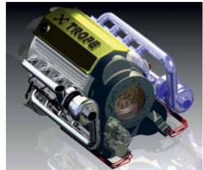
Constructeur Devaere doopte zijn ronde motor TROPE, voor Toroidal Opposed Piston Engine. Aan twee kanten ziet u onder de uitlaat, boven de inlaat en ertussen inspuiventielen. Er zouden hier viermaal vier zuigers aan het werk zijn.
