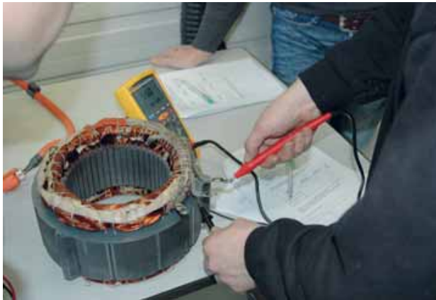
Leerzaam practicum. De standaard multimeter schiet tekort bij weerstandsmetingen aan het HV-systeem. Deze Mega Ohmmeter geeft wel het goede resultaat.
