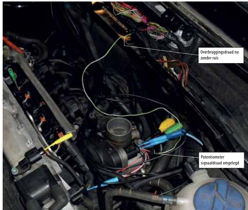
De bewuste Lupo tijdens de diagnose. Het probleem werd veroorzaakt door een probleem in de bekabeling. Met een aparte draad tussen gasklephuis en stuurapparaat was de storing opgelost. Daarna is de kabelboom permanent gerepareerd.
