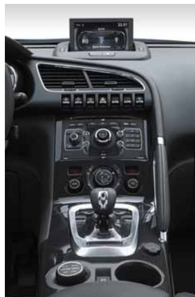
De keuzeknop achter de automaatpook is eerder een aardig bewijs dat er een elektromotor is, dan dat het erg zinvol is iets anders dan de 'auto' stand te kiezen.
