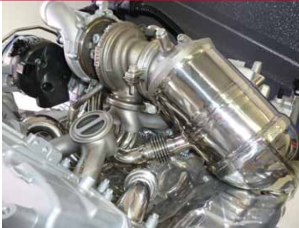
Twee turbo's tussen de cilinderrijen, waarvan hier eentje is verwijderd, zijn zodanig aangesloten dat de uitlaatgasstroom optimaal gelijkmatig is.
