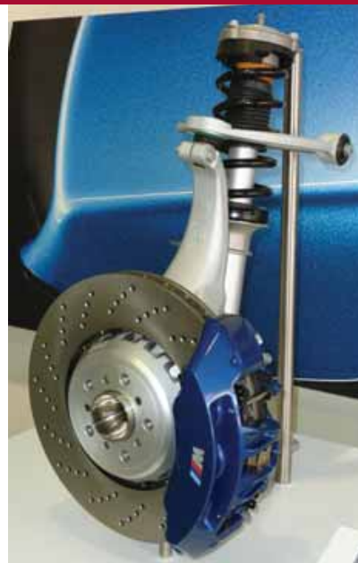
Zwevende zeszuiger remklauwen uit één stuk aan de voorwielen zijn ook een speciale toevoeging van de M-afdeling.
