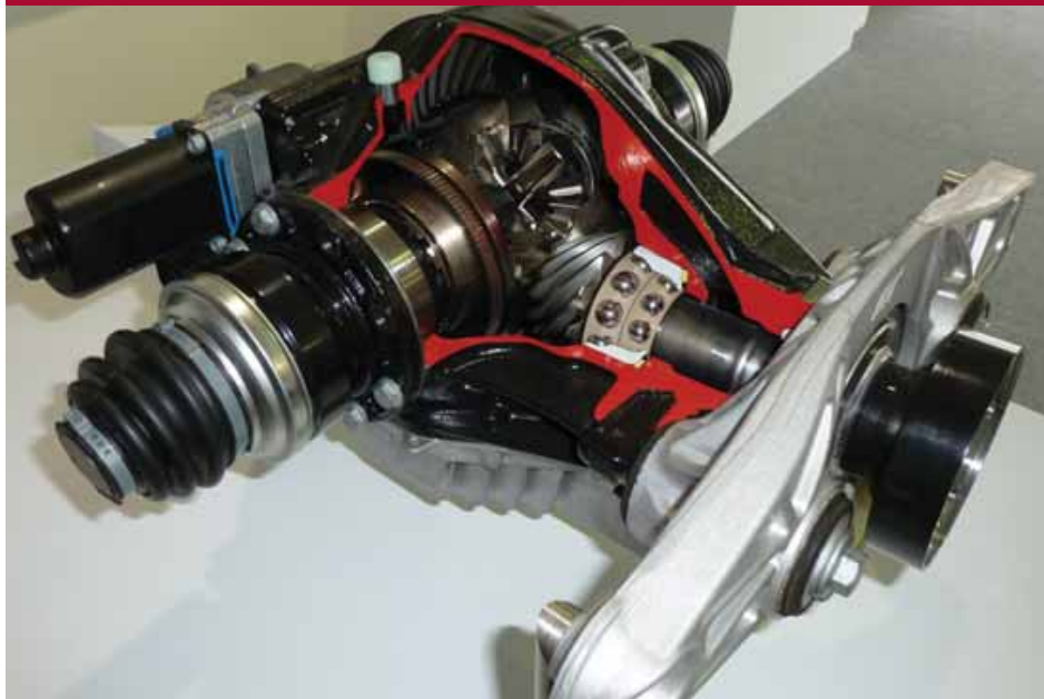
Een blik in het elektrisch traploos variabel sperdifferentieel, met achterop het stelmotortje voor de regeling. Op de aandrijfas aan deze zijde de drukschijf, waarachter de platenkoppeling zit voor de spierwerking.
