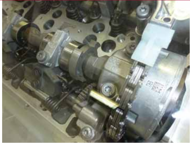
Naast variabele nokkenastiming nu ook traploze variatie van de kleplichthoogte, door BMW M geschikt gemaakt voor hogere toerentallen. De Valvetronic-verstelling zit hier onder de inlaatnokkenas.
