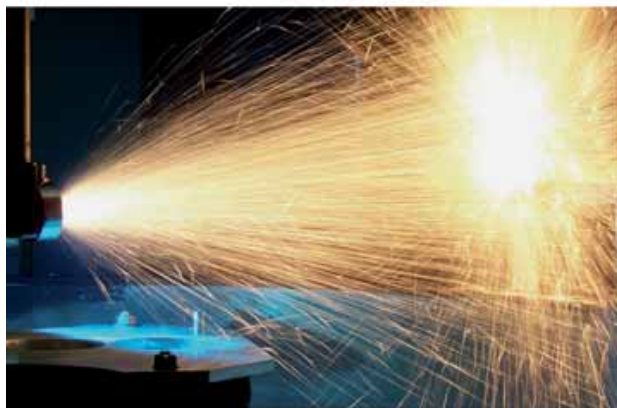
Lichtbogendrahtspritzen, LDS-methode om een op ijzer gebaseerde looplaag op een aluminium cilinderwand te spuiten.
