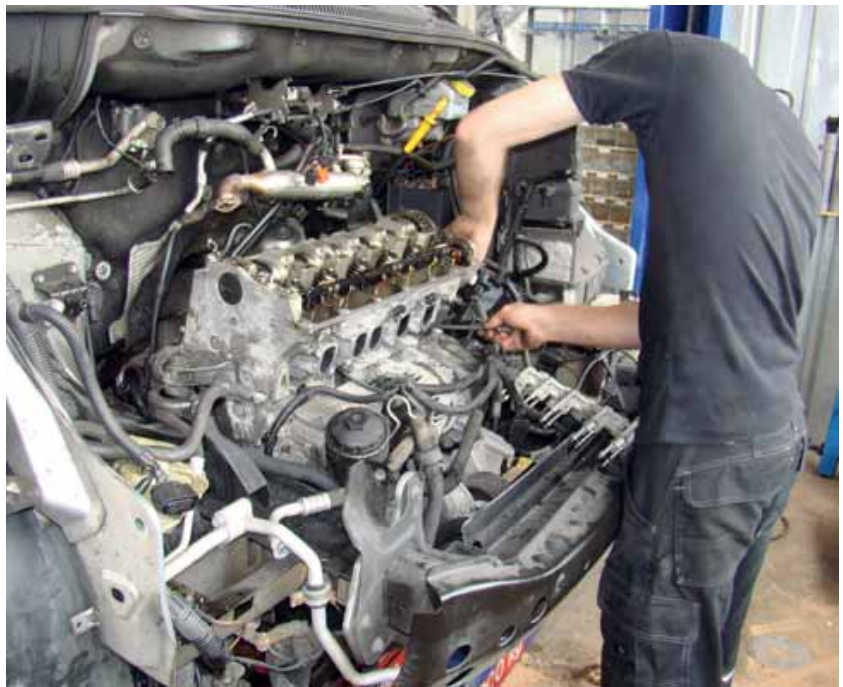
Even een tapeind vervangen van het uitlaatspruitstuk liep uit op een groot fiasco. Tijdens het uitboren boorde Bram door de kop waardoor er koelvloeistof in het carter lekte.
