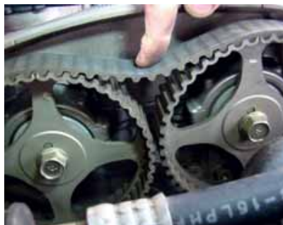
Normaal gesproken is de spanner verantwoordelijk om de riem strak te houden om de tandwielen maar in dit geval is het Bram's vinger die deze taak verzorgt. Oorzaak? Tijdens het vervangen van de riem was men de spanner 'vergeten'.
