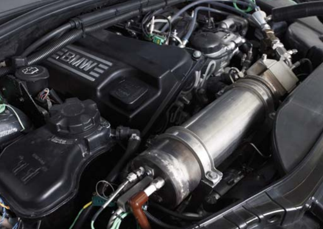
Een buis onder de motorkap met injector, bougie en katalysator.
