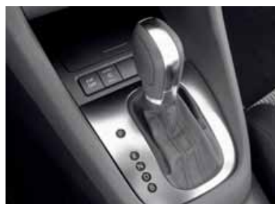
Geen standaard automaatpook, bij nadere blik. De stand B is eigenlijk overbodig geworden, die dient voor maximale regeneratie, wat ook met stuurflippers ingesteld kan worden. Naast de ESP-schakelaar de keuzeknop voor drie rijprogramma's.
