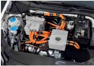
Blik in de motorruimte, met helemaal onderin de elektromotor. Links erboven de stroomregeling, middenvoor het laadapparaat, daaronder de ééntrapstransmissie.
