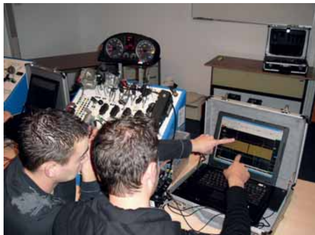
Trainen bij GMTO, een compleet autosysteem op het meetbord en meten met de scoop.
