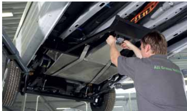
Deze MAN AGV TGL-E 'distributietruck' is volgeladen met zes batterijpakketten met een capaciteit van 120 kW. De in Canada geproduceerde elektromotor levert 150 of 180 kW, de actieradius ligt tussen de 150 en 180 km en het extra gewicht van deze versie bedraagt 400 kg. De motor is gepositioneerd midden tussen de voor- en achteras.
