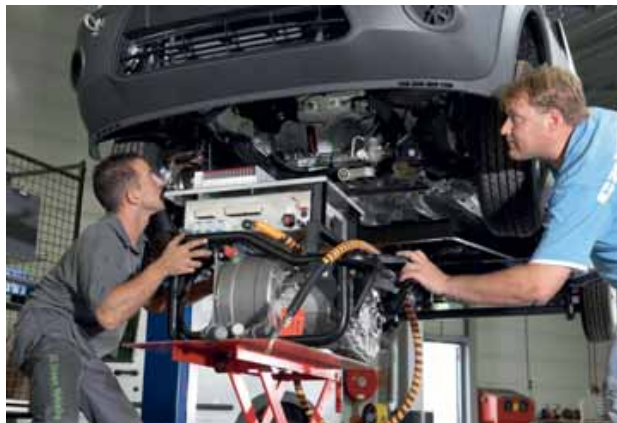
Dit is waar het allemaal om draait bij AGV: de samensmelting van de vloeistofgekoelde driefase elektromotor inclusief omvormer en regelelektronica met de van oorsprong voor fossiele brandstof ontwikkelde body.
