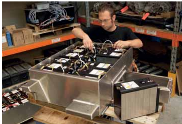
Het batterijpakket bestaat uit de laatste generatie (vierde) Lithium-ion-polymeercellen. Iedere cel is voorzien van een bewakingsysteem dat waakt over de werkomstandigheden en zonodig een cel uitschakelt. Op deze afdeling maken de werknemers tevens de kabelbomen en passen ze het dashboard aan op het 'elektrisch bedrijf'. De brandstofmeter geeft dan de accu-capaciteit aan.
