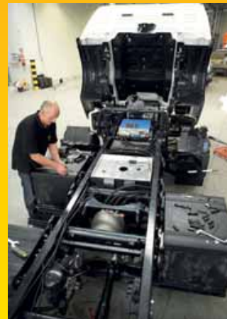
Deze MAN AGV TGL-E 'distributietruck' is volgeladen met zes batterijpakketten met een capaciteit van 120 kW. De in Canada geproduceerde elektromotor levert 150 of 180 kW, de actieradius ligt tussen de 150 en 180 km en het extra gewicht van deze versie bedraagt 400 kg. De motor is gepositioneerd midden tussen de voor- en achteras.
