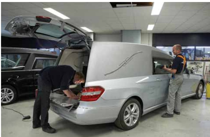
Hier is de krachtige belijning, die aansluit op de vormen van de originele S212, bij het achterlicht en over de achterdeuren goed zichtbaar. Aan de achterkant is onder de neerklapbare klep een onderrijdbeveiliging zichtbaar. Deze beschermingsbeugel klapt automatisch uit en beschermt de bumper tegen schade door het schaarwagentje.
