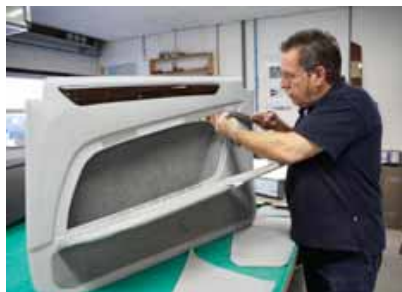
De klant is koning. Hier voorziet Tonny Theissen het deurpaneel van een extra grote opbergruimte. De opdrachtgever wil de condolanceregisters namelijk onder handbereik hebben.
