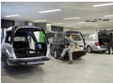
Drie keer de nieuwe Huiskamp E212 in de vijfdeurs-uitvoering; links en midden in de 'Glass'-uitvoering, rechts in de 'Landau'-uitvoering. Let bij de auto links op het stalen frame waar later de vloer op gemonteerd zal worden.
