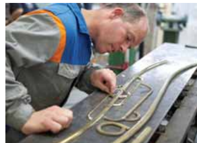
Jos Eekelder maakt een slagschaar van messing. Een slagschaar had vroeger een functie bij het openen en sluiten van het canvasdak, maar tegenwoordig dient de slagschaar slechts ter verfraaiing van de Landau-uitvoering.
