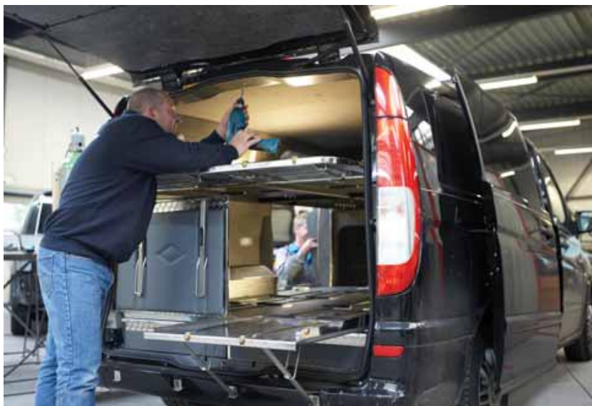
Rouwvervoer vindt in Duitsland vaak met meerdere kisten tegelijk plaats, omdat de crematieceremonie meestal op een ander moment plaatsvindt. Patrick Hoefsmit werkt hier aan een Mercedes Vito met een elektrisch in hoogte verstelbare vloer. Er kunnen vier kisten in.
