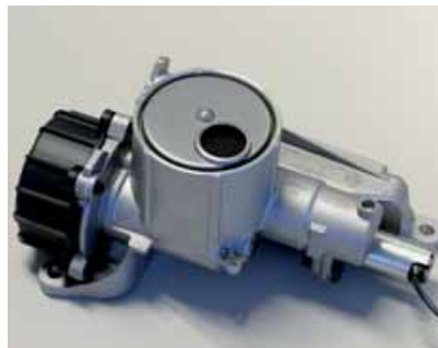
Er wordt een kenveldgestuurde oliepomp toegepast die het gewenste olievolume regelt zonder overdrukklep. Dat bespaart aandrijfvermogen en levert dus een lager brandstofverbruik op. De pomp wordt door een ketting aangedreven.
