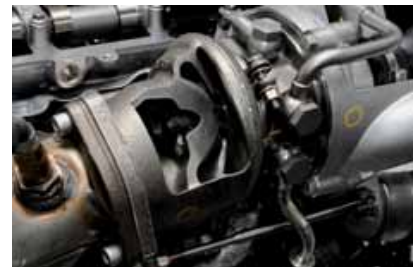
Om de turbine snel op toeren te krijgen, wordt er puls- of stootdruk vulling toegepast. De uitlaatgassen van cilinders 1 en 4 en die van 2 en 3 worden gescheiden naar het turbinehuis gevoerd en komen via aparte kanalen op het turbinewiel terecht. Dit type turbo wordt met 'Twin-Scroll' aangeduid, letterlijk vertaald: tweeling krul.
