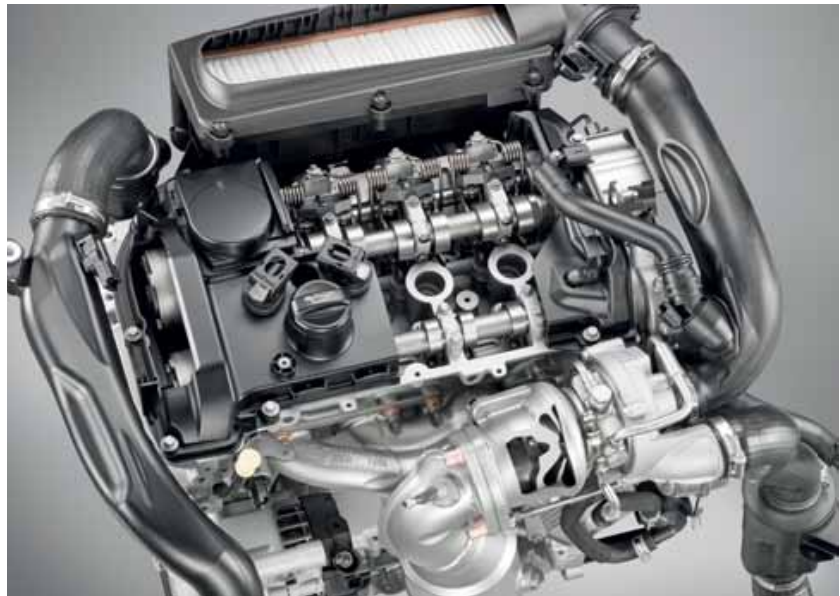
Het is vol in de cilinderkop omdat er naast de directe inspuiting ook ruimte nodig is voor de variabele inlaatklepbediening en de bougies, elk met een eigen bobine.
