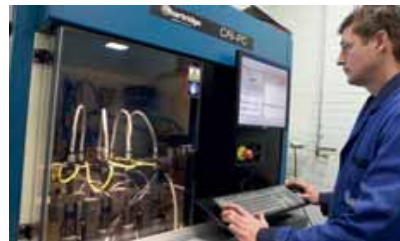
Alle gereviseerde injectoren doorlopen een programma op de testbank om te bepalen of ze voldoen aan de fabrieksspecificaties. Hiermee is de kwaliteit gegarandeerd.
