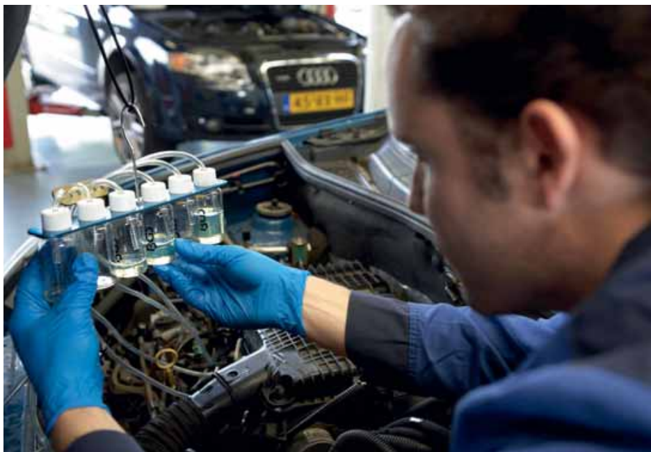
De retourmeting geeft belangrijke informatie over de onderlinge verschillen tussen de injectoren. Beseft echter wel dat deze methode niet werkt bij de piëzo injectoren, daar is een tegendruk van minimaal 10 bar nodig voor de retourmeting.
