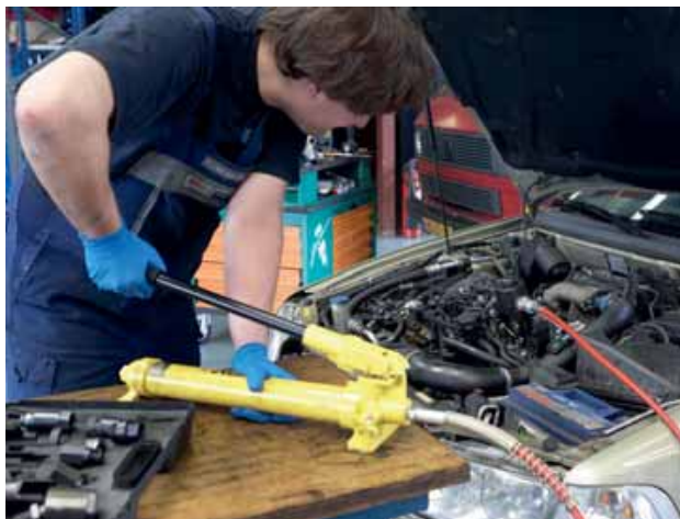
Soms is er nogal wat geweld nodig om een injector uit de kop te halen. Volgens de mannen van Terlouw is dit nog steeds de meest effectieve methode.
