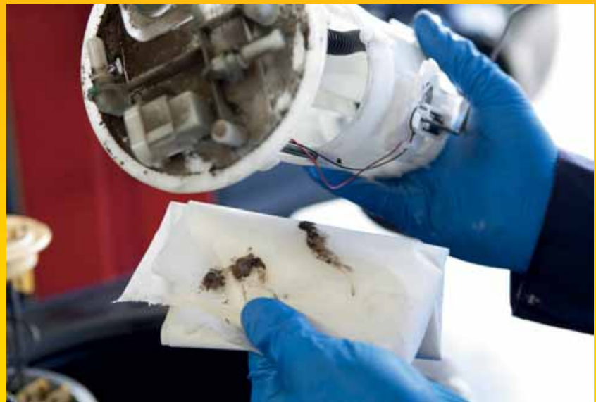
Vuil, een hardnekkig en dodelijk probleem voor de moderne diesel. Schoonmaken begint echter al in de tank, hier ziet u een vlotterelement waarop zich het nodige gruis en vuil heeft verzameld.
