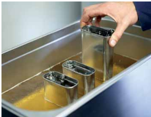
Alle onderdelen van de te reviseren injector worden verzameld in een blikje en blijven zo bij elkaar. Voordat ze überhaupt de cleanroom in mogen worden ze eerst intensief gereinigd in een ultrasoon bad.
