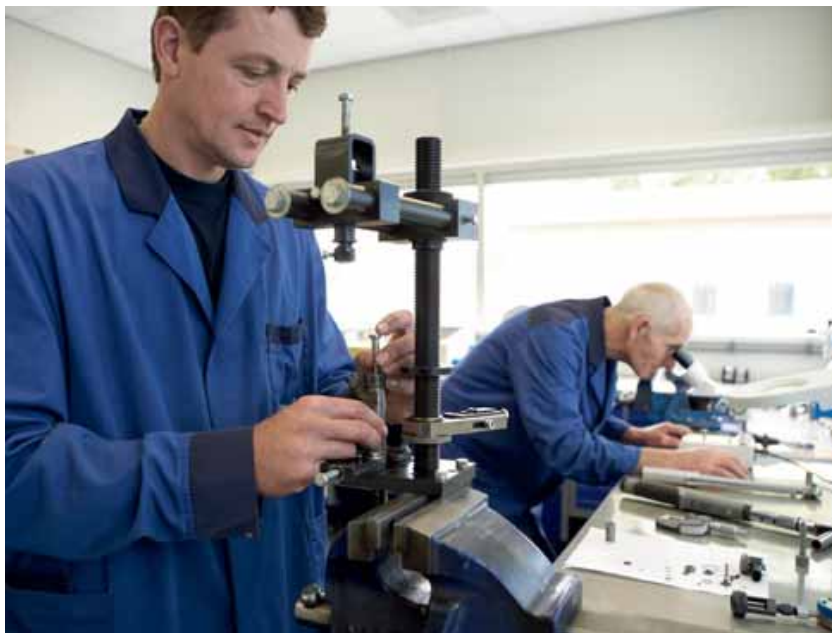
De gereviseerde injectoren worden gemonteerd in de zogenaamde cleanroom, waar een constante overdruk heerst. Hierdoor voldoet het stofgehalte aan de norm die door de injectorproducent is gesteld en wat natuurlijk borg staat voor een bepaalde kwaliteit en levensduur.
