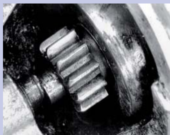
Een hard metalen geluid tijdens het starten en de motor slaat niet aan. Niet vreemd, de as is gebroken. Oorzaak: er is een starter met te groot rondsel gemonteerd.
