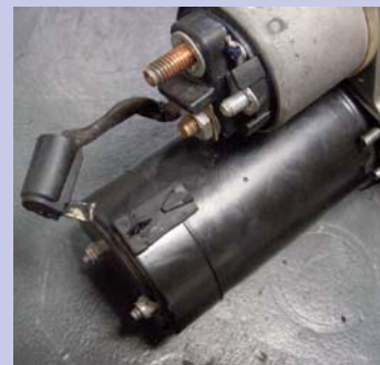
De sticker toont sporen van extreme hitte, de aansluiting naar de motor is verbrand en de rondsel is blauw. Hoe dat kan? Het rondsel zat vast in het vliegwiel en is gecentrifugeerd. Oorzaak: defect in het contactslot.
