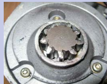
Verkeerde toepassing. Het rondsel greep niet in het vliegwiel maar kwam er alleen maar tegenaan.
