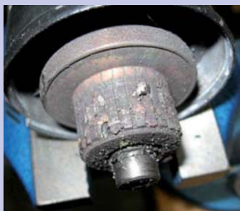
Bij lang doorstarten komen de koperen stripjes van het sleepcontact los.
