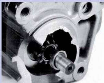
Starter met gebroken neus. Waarschijnlijk een montagefout. Toch is deze claim toegewezen. Een fout in het aluminium gietwerk is namelijk niet helemaal uit te sluiten.
