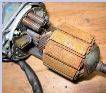
De motor is afgestoomd. Vuil en vocht hebben de startmotor geruïneerd.
