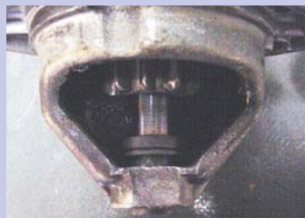
De sticker toont sporen van extreme hitte, de aansluiting naar de motor is verbrand en de rondsel is blauw. Hoe dat kan? Het rondsel zat vast in het vliegwiel en is gecentrifugeerd. Oorzaak: defect in het contactslot.
