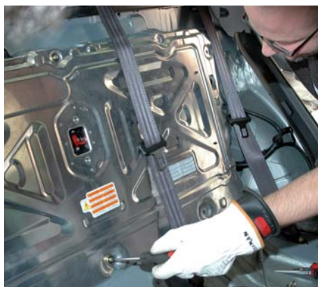
Rubber handschoenen aan, hoofdschakelaar uit, de beschermplaat mag los.
