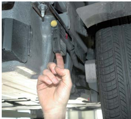
Trek die module er uit en de Elect' Road is spanningsloos.
