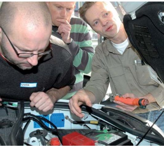
Onderzoek onder de kap van de Renault Kangoo Elect' Road. Hoe wordt de interieurverwarming verzorgd?
