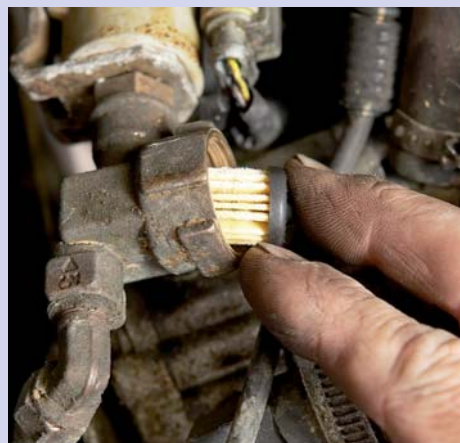
De LPG-installatie heeft tijdens een onderhoudsbeurt ook aandacht nodig. Vervang om de 2 jaar de filterunit en het filter in de gasafsluiter op de verdampert.
