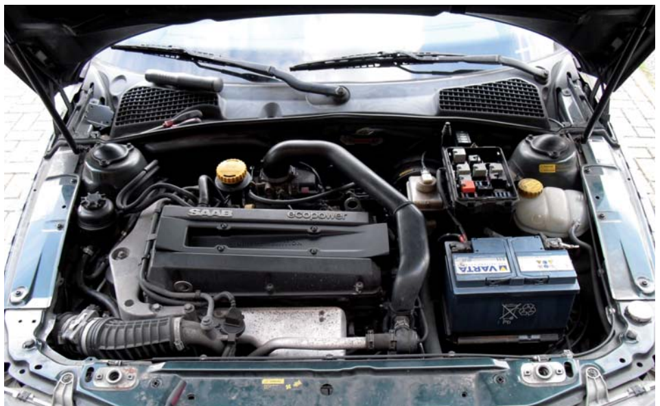
De Saab is voorzien van een speciaal DI-ontstekingsstelsel. Het wordt al ruim 20 jaar toegepast en werkt anders dan gebruikelijk. Opletten dus bij de diagnose!
