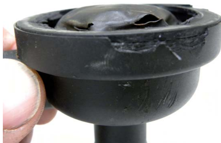
Het membraan van het carterontluchtings-omloopssysteem van de Audi A4 was op twee plaatsen gescheurd waardoor de motor bij lage toerentallen valse lucht aanzooog.
