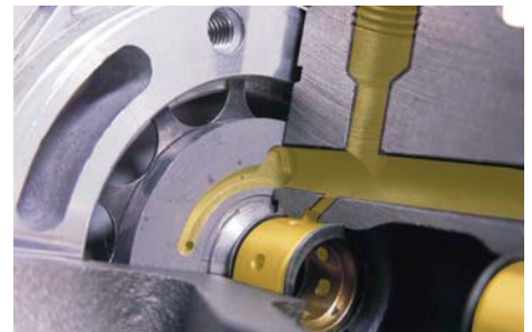
De turbo-as (hier weggelaten) is zwevend gelagerd. Zolang er geen oliedruk is, geeft dat speling. Olie in de sleuf in de achterplaat van het compressorwiel verzorgt de axiaalagering.
