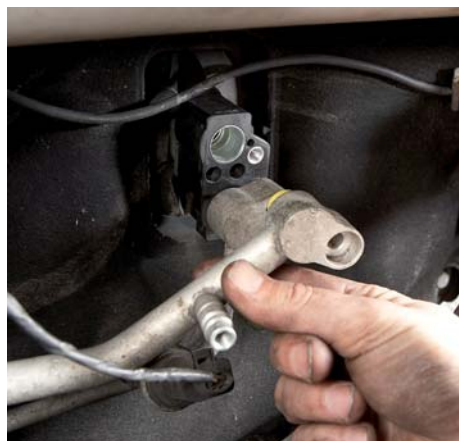
Met een speciale adapter spoelt u de verdamper.
