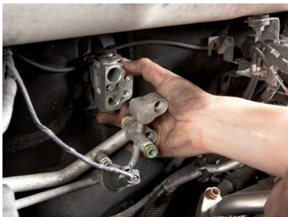
U dient tijdens het spoelen het expansieventiel te verwijderen.
