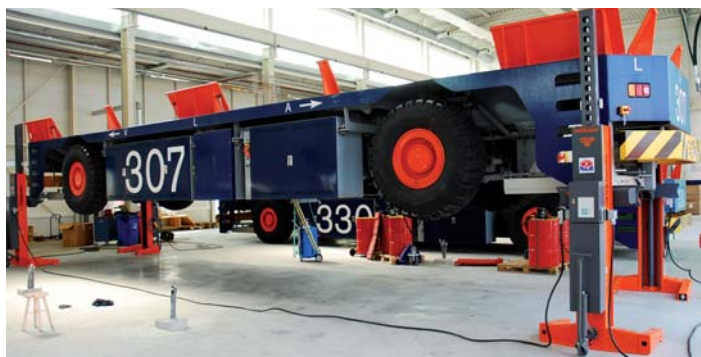
De AGV's (Automatically Guided Vehicles) van havenbedrijf ECT zijn ontworpen voor heffen met mobiele kolommen.
