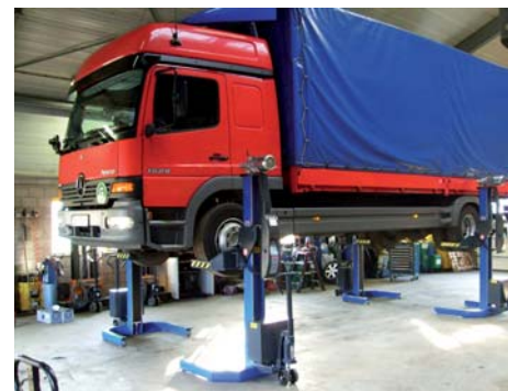
Liggen de draden in de weg? Draadloze hefkolommen hebben een accu aan boord en synchroniseren radiografisch.
