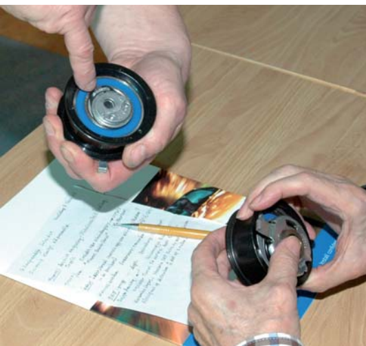
“Eigenlijk best een goede spanrol”, zegt Amsing over het exemplaar op de VW 1.9 TDI-motoren. “Maar je moet ‘m wel goed afstellen.”
