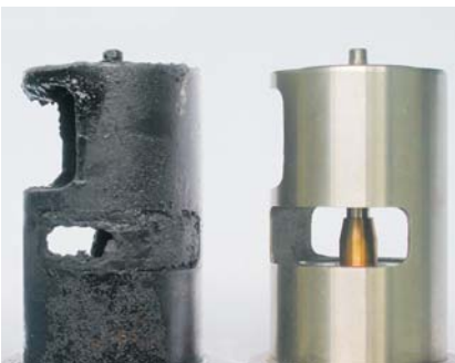
Vervuilde EGR-klep. Wat is de oorzaak en vooral: hoe los je het op?
