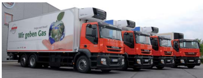
De koelwagens van Meyer Logistiek rijden op aardgas. De koelmotoren zijn elektrisch aangedreven. Een generator op de PTO van de aardgasmotor zorgt voor stroom.
