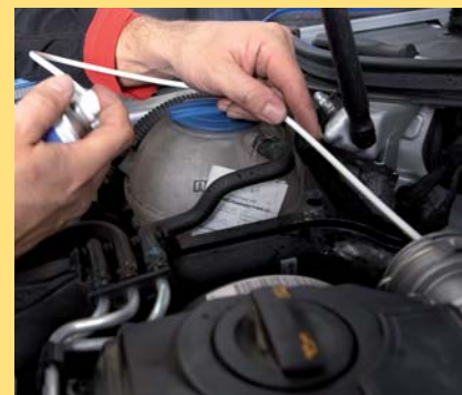
Reinigen met de spuitbus. Let op: de motor draait!
