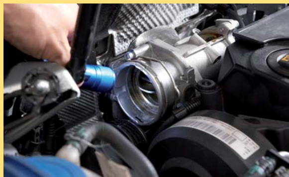
VW Passat 1.9 TDI met 70.000 km: beginnende vervuiling in de luchtinlaat.
