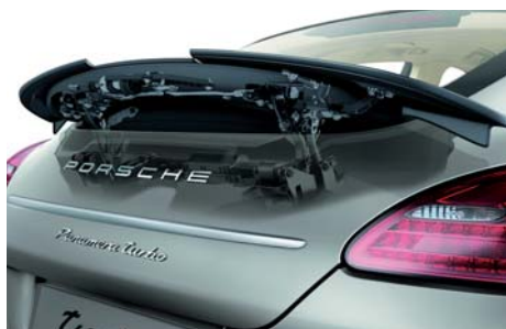
Een bij hoger tempo opklappende spoiler kenden we al bij Porsche. Hier schuiven ook nog eens de randen uit om de spoiler te verbreden. Dat klap-schuifmechaniek blijkt bepaald geen simpele constructie.
