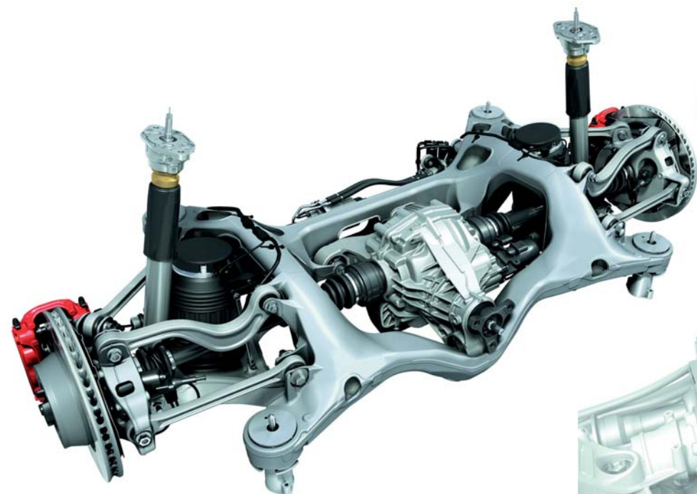
De wielophanging van de Panamera is geheel van aluminium, zoals hier de achteras met subframe. Achterop is nog juist de hydraulische cilinder met aansluitlangen te zien van de regelbare stabilisator.
