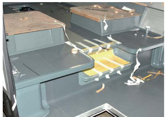
Achterin een opstapje. Dat mag, de Ambassador is een streekbus. Let op de afgeronde hoeken, maakt makkelijk schoon.
