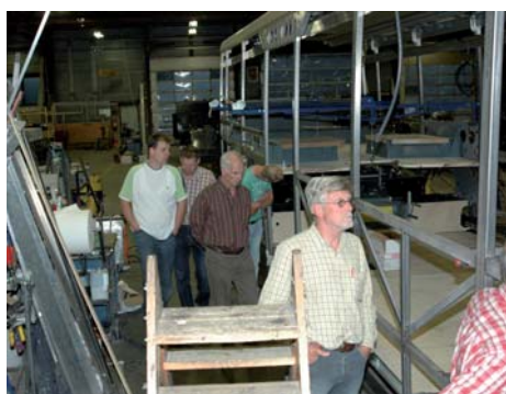
Tussen de beide chassisdelen komt een vloer van sandwichmateriaal versterkt met een verzinkt stalen frame. De zijkanten zijn opgebouwd uit een roestvaststalen vakwerk.
