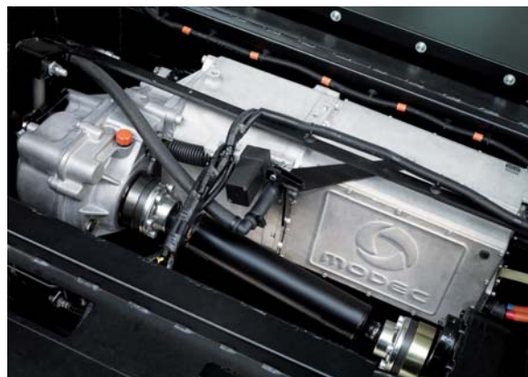
De motor is gesitueerd aan de achterzijde van het voertuig, de borstelloze elektromotor levert 102 pk en 300 Nm.
