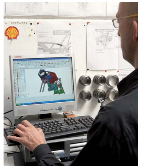
Ontwerpen achter de computer, kijken of het past en eventueel de sterkte doormeten, het lijkt kinderspel. Een ander groot voordeel is dat je zo alle maten digitaal hebt en door kan spelen naar bijvoorbeeld een gieterij om een dekseltje te laten gieten.
