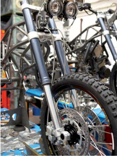
De upside-downvoorfork komt van WP, momenteel het beste van het beste wat er te koop is.
