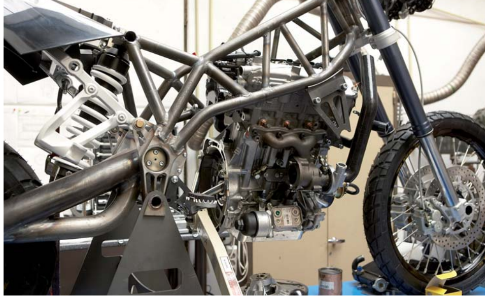
Elf prototypen gingen eraan vooraf voordat de uiteindelijke vorm van het frame was bepaald. Veel driehoekjes voor de stevigheid en een motorblok dat deel uitmaakt van de framebouw. Overeenkomstig de huidige standaard.
