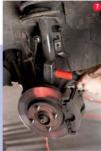
7 Dus niet, die schokdemper zit echt klem. Dit soort tegenslagjes draagt ertoe bij dat vervangen van veerpoten nogal wat tijd kost. Met beleid een wat zwaarder gereedschap er tegenaan, om de wieldrager toch los te krijgen.
