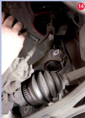
14 Een zaklampje bewijst goede diensten om te controleren of alles recht zit, en de veerpoot tot aan zijn stootrand in de wieldrager steekt.
