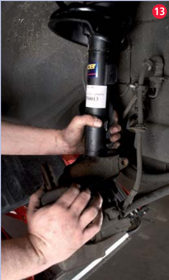
13 Nu keurig recht de nieuwe veerpoot oplijnen met de klemopening in de wieldrager. Secuur werken, als de veerpoot scheef in het gat steekt krijg je hem er nooit helemaal doorheen.
