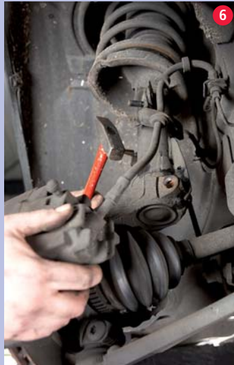
6 Zo, nog even de wieldrager lostikken, dan is de veerpoot onderaan vrij.
