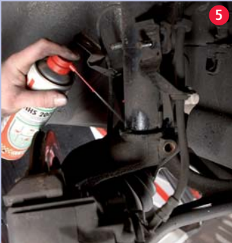
5 Een beetje smeren kan zeker geen kwaad, alles op en om de veerpoot vangt immers continu straatvuil.
