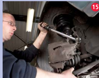
15 Die zit! Nu vastklemmen met de momentsleutel. Want: niet te los, dat de veerpoot gaat draaien in de wieldrager, en niet te vast waardoor de demperbuis vervormd kan raken.
