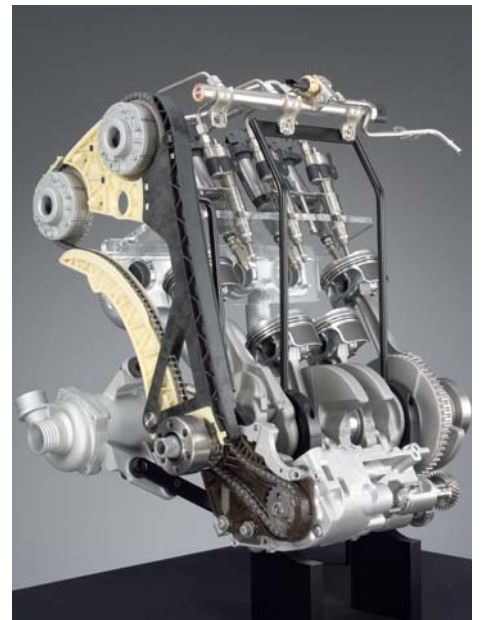
De bovenliggende nokkenassen, elk met een VANOS-systeem, de oliepompe en de balansassen worden door kettingen aangedreven. Elke cilinder heeft maar één contragewicht.
