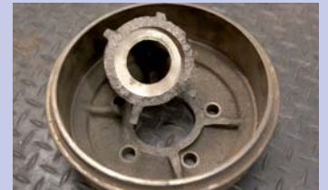
Als het niet wil zoals het moet, dan moet het zoals het wil. Alleen hier brak de flens van de trommel toen de monteur trachtte een verkeerd lager in de trommel te persen.
