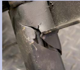
Scheuren in dragende delen door ondegelijke vering.
