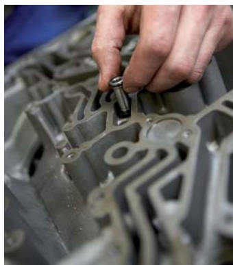
De olietoevoerbusjes kunnen terug in de commando-unit.
