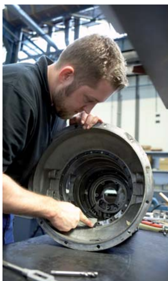
Is het huis niet te zwaar beschadigd, komen de onderdelen er in terug. Het huis is al ontverfd en schoon. Jeroen verwijdert nog wat pakkingresten.
