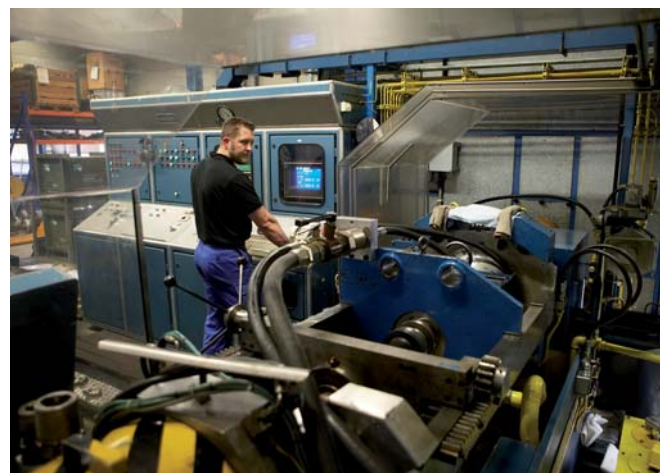
Zwaar onderdeel van het testprotocol: de 'stall-test'. Eén voet op de rem, de andere op het gas en kijken of olieopbrengst en koppeloverdracht voldoende zijn. Niet langer 'stallen' dan 30 seconden, anders moet de revisie opnieuw.
