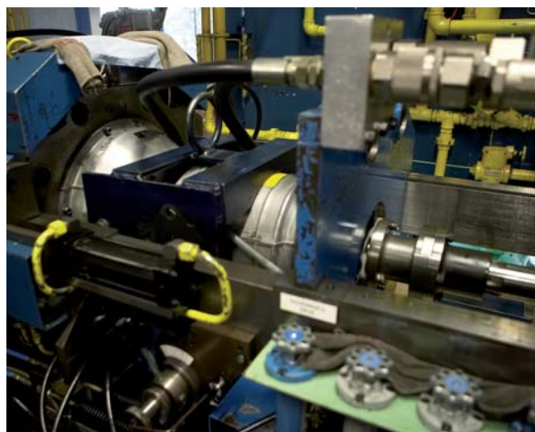
In de YPR zit de bak tussen motor en verdeelbak, die de aandrijfkracht over beide tracks verdeelt. Op de testbank zit de bak ingeklemd tussen twee platen, met aan de ene kant een grote V12 en aan de andere een motorrem.
