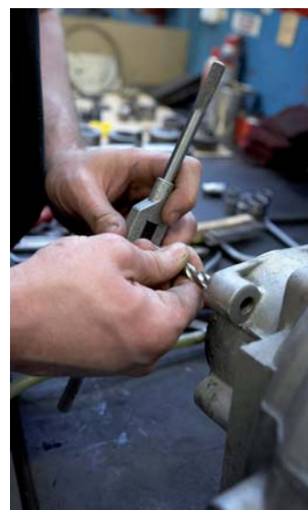
Is het schroefdraad beschadigd, dan plaatst Jeroen een Helicoil. In dit geval volstaat even opzuiveren.
