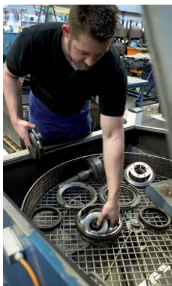
Schoon en nauwkeurig werken is belangrijk, dus krijgen de onderdelen eerst een wasbeurt.
