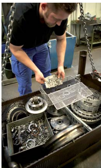
Het begin van een transmissierevisie bij IBL. De onderdelen van een gedomonteerde Allison YPR automatische transmissie in een stalen mand.
