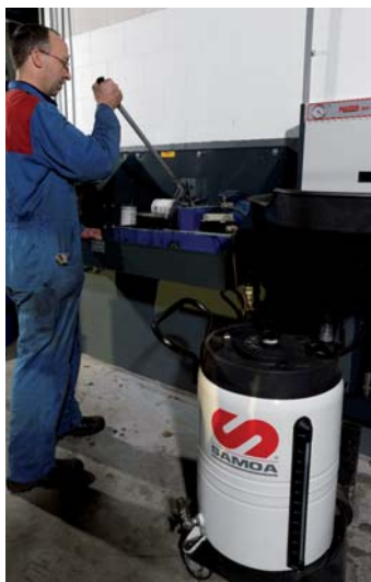
Dubbelfunctie voor de afgewerkteolie-pomp. Eén: de olie uit de Samoa-trolleys. Twee: de olie uit de filtersnijbak.
