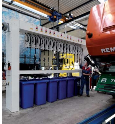
Op maat gemaakt kabinet met zestien aftappunten. Op iedere haspel zit 15 meter slang voor optimale bereikbaarheid.
