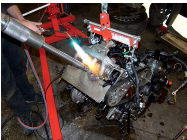
Heb je de motor zo ver blootgelegd dat je fatsoenlijk bij de verstuivers kan, blijken ze muurvast te zitten.
