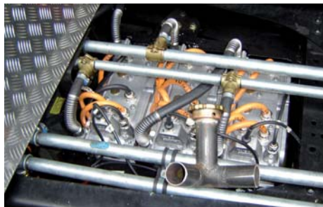
De omvormers zijn gepositioneerd achter de generator tussen de chassisbalken, ze worden gekoeld met koelvloeistof.
