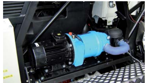
Deze unit drijft de airco en luchtpomp aan van de truck. Maar de DAF-motor is toch nog volledig intact, horen we u denken. Klopt, maar tijdens de emissieloze 'loop' moeten die ook aangedreven worden.
