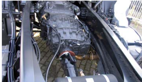
De versnellingsbak inclusief de cardanas maken plaats voor de generator en de elektrische aandrijfmotor.
