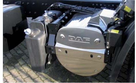
De DAF is uitgevoerd in een Euro 5-uitvoering, dus met een SCR-katalysator en AdBlue-toevoeging. Op zich dus al een schone uitvoering.
