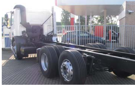
De basis van de innoverende huisvuiltruck betreft een DAF CF 75-chassis met een laadvermogen van 26 ton.
