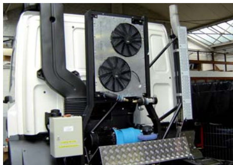
Voor de elektrische hardware zijn extra warmtewisselaars nodig.
