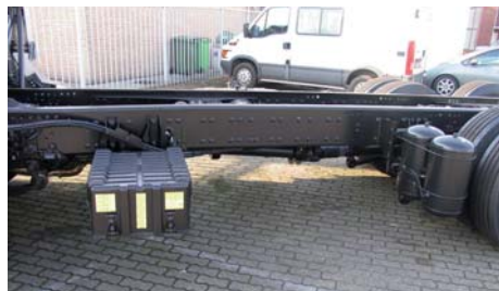
De originele 24 Volt installatie blijft uiteraard intact en dat impliceert een behoorlijke accubak. In de vrije ruimte tussen de bak en de achteras komt het Lipo-pakket en de supercondensatoren.
